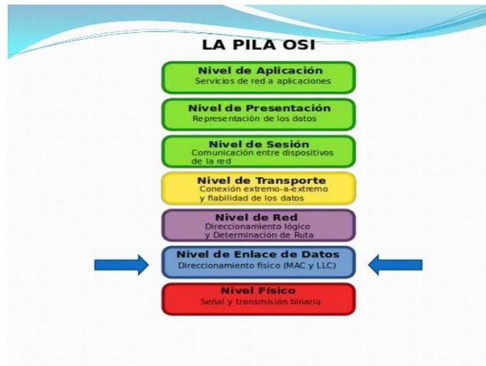
La tarea principal de la capa de enlace de datos es tomar una transmisión de datos y transformarla en una abstracción libre de errores de transmisión para la capa de red. Logra esta función dividiendo los datos de entrada en marcos de datos, transmite los marcos en forma secuencial, y procesa los marcos de estado que envía el nodo destino.
